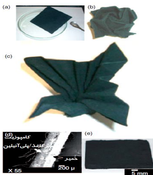
شکل ۵- (a) کاغذ رسانا بر پایه کامپوزیت خمیرکاغذ/ پلی‌آنیلین تهیه شده با تکنیک فرآوری؛ (b) یک کاغذ رسانا حجیم شده، (c) کشیده شده، (d) تصویر SEM از برش عرضی دو لایه ورقه خمیر و کاغذ/ پلی‌آنیلین، (e) نمونه ضخیم (۵).
